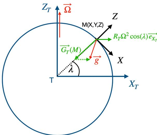
FIGURE 2 – Définition du poids d'un objet : somme de la force d'inertie d'entraînement et de l'attraction gravitationnelle terrestre.
