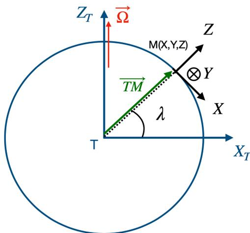
FIGURE 1 – Paramétrage du problème. On exploite ici la symétrie sphérique supposée de la terre, qui permet de ne repérer un objet à la surface de la Terre que grâce à la latitude.
