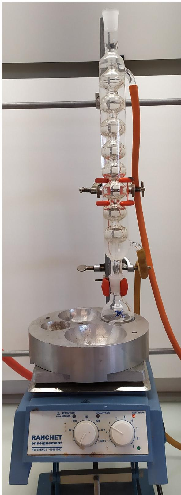
FIGURE 1 – Montage à reflux
